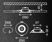
PROFONDEUR D'INSTALLATION | MOUNTING DEPTH | **EINBAUTIEFE 40MM**
