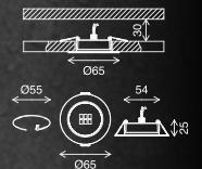
PROFONDEUR D'INSTALLATION | MOUNTING DEPTH | EINBAUTIEFE **30MM**
